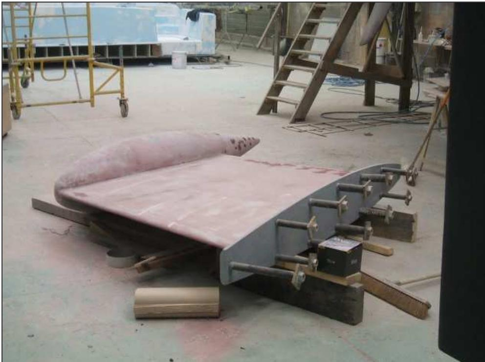
**Autre exemple** d'une quille en plomb allié avec 4% d'antimoine sans platine de fixation fixée sous la coque à l'aide de boulons M30 de 25,7 mm de  $\varnothing$  à fond de filet.
