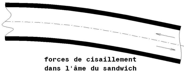
L'échantillon sera détruit sous une charge environ de 260 kg. L'âme en mousse donne la limite de la résistance alors que l'UD n'aura pas atteint son maximum. Avec un UD de carbone, la flèche passe à 0,16 mm et
