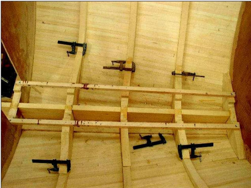
Exemple de membrures dévoyées dans la cabine avant de « Maximus » avec la même cote  $x$  à la quille et au livet.
