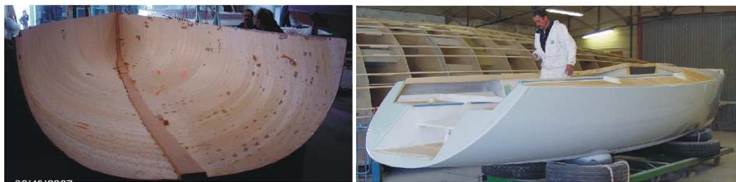
Le bordé est ensuite stratifié pour le rigidifier davantage et protéger le bois, avant la pose des aménagements et du pont. Cette procédure est mécaniquement performante mais demande un certain doigté pour la mise en œuvre car toutes les lattes doivent être ajus-
